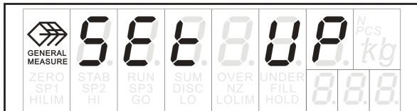
在整个设置过程中，主显示为实际参数值，副显示为参数代号 XX。按 **↑ TARE** 键可改变参数值，需要数据输入的可用 0~9 数字键完成，所有需要用数字键输入的参数低位闪烁。
